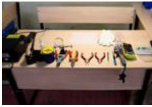
Оборудование используется для сборки и пайки микросхем, мелких деталей при сборке конструктора "Клевер" - беспилотный летательный аппарат. Для самостоятельной сборки и устранения неполадок. В техникуме имеется 5 комплектов оборудования рабочего места для осуществления сборки.
